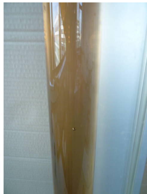
Abb. 26: Fallende Kugel im Kugelfallviskosimeter.
