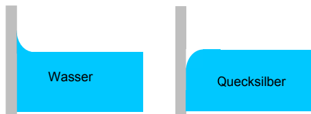
Abb. 12: Von einer Flüssigkeit benetzte (links) und nicht benetzte (rechts) Gefäßwand.
