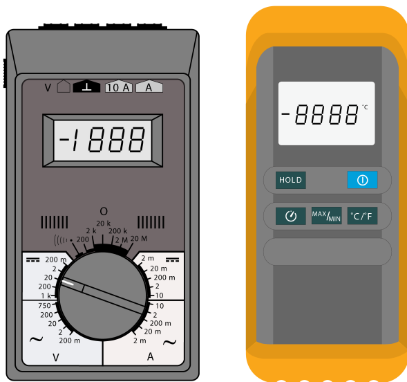
Abb. 8: Links: Multimeter. In die COM-Buchse (schwarz) wird der Minuspol gesteckt. Für den Pluspol sind für Strom- oder Spannungs- und Widerstandsmessungen verschiedene Buchsen vorgesehen. Sie unterscheiden sich durch die Kennzeichnung A bzw. V, Ω. Mit dem Drehschalter wird der gewünschte Messbereich gewählt: Wechselspannung, Gleichspannung, Wechselstrom, Gleichstrom. Die Einstellung sollte aus Gründen der Genauigkeit möglichst empfindlich sein. Der Messwert wird an der Digitalanzeige abgelesen. Die Einheit ergibt sich bei manchen Geräten aus dem eingestellten Messbereich. Die Messgenauigkeiten der Geräte werden vom Betreiber angegeben. Rechts: Elektronisches Thermometer mit eingebauter Stoppuhr. Der Thermoelement-Messfühler wird an der Frontplatte angeschlossen (auf richtige Anschlussweise achten).
