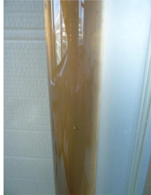
Abb. 26: Fallende Kugel im Kugelfallviskosimeter.
