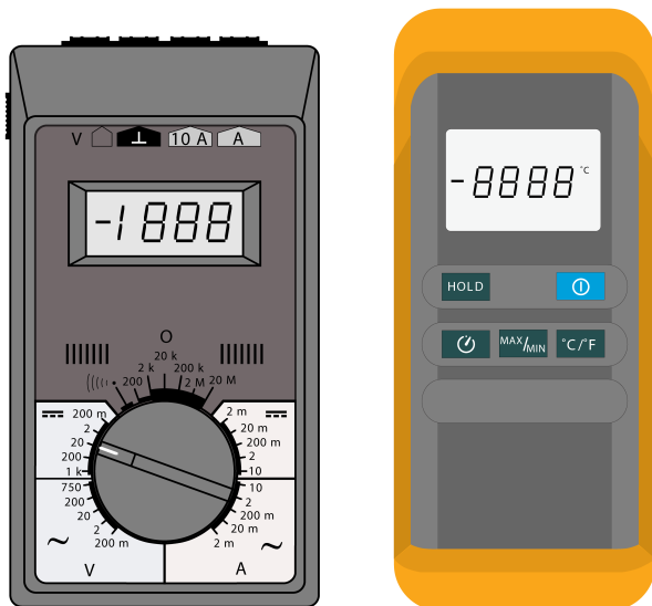
Abb. 8: Links: Multimeter. In die COM-Buchse (schwarz) wird der Minuspol gesteckt. Für den Pluspol sind für Strom- oder Spannungs- und Widerstandsmessungen verschiedene Buchsen vorgesehen. Sie unterscheiden sich durch die Kennzeichnung A bzw. V, Ω. Mit dem Drehschalter wird der gewünschte Messbereich gewählt: Wechselspannung, Gleichspannung, Wechselstrom, Gleichstrom. Die Einstellung sollte aus Gründen der Genauigkeit möglichst empfindlich sein. Der Messwert wird an der Digitalanzeige abgelesen. Die Einheit ergibt sich bei manchen Geräten aus dem eingestellten Messbereich. Die Messungenauigkeiten der Geräte werden vom Betreuer angegeben. Rechts: Elektronisches Thermometer mit eingebauter Stoppuhr. Der Thermoelement-Messfühler wird an der Frontplatte angeschlossen (auf richtige Anschlussweise achten).
